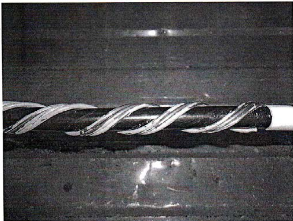
Испытание по проверке прочности заделки провода СИП-3х50 изд. "Вязка спиральная" ВС 50-95. Образец № 2 до испытания
